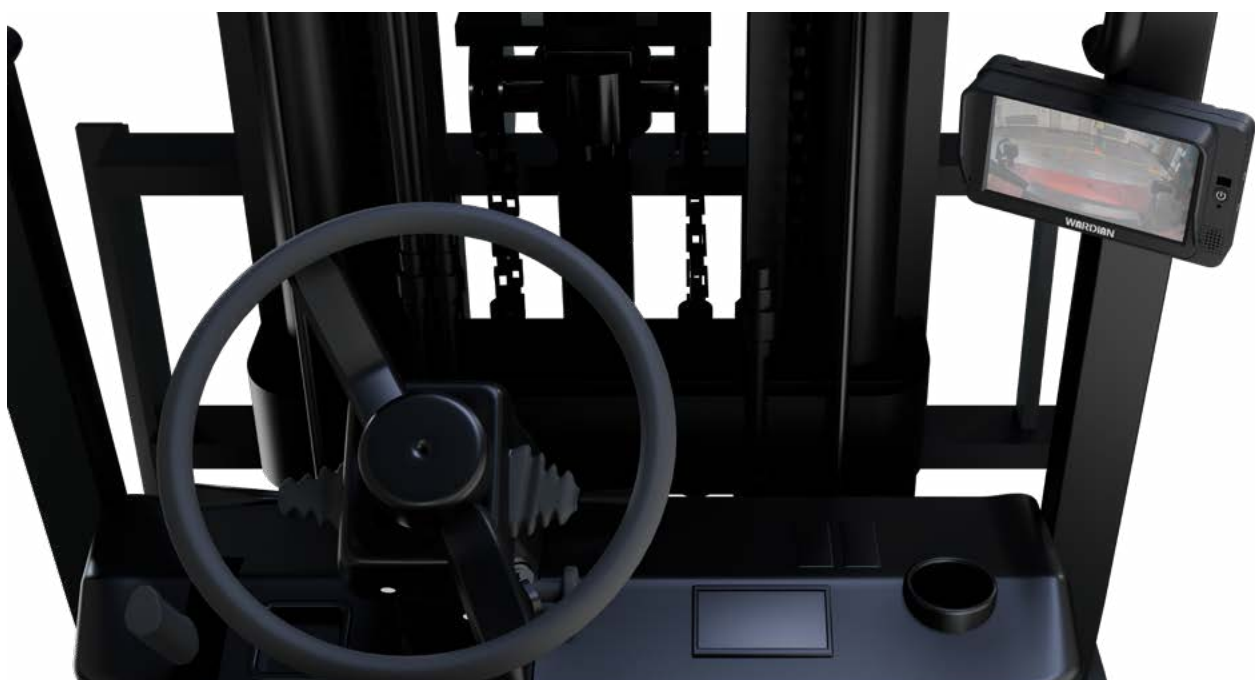
Obr.2 Ilustrační obrázek doporučeného místa instalace monitoru do kabiny VZV
