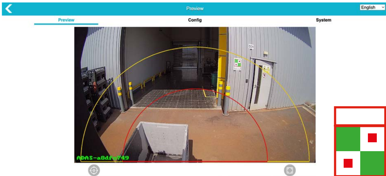
Obr. 14 Aktivace zónového zpomalení VZV
